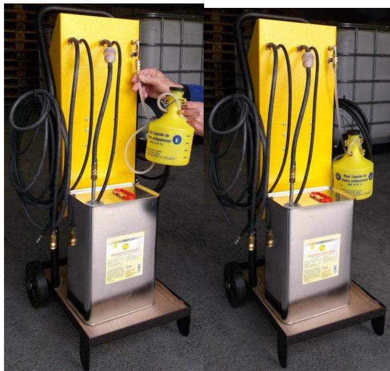
Jetzt schließen Sie bitte den Auffangbehälter für die alte Bremsflüssigkeit,
