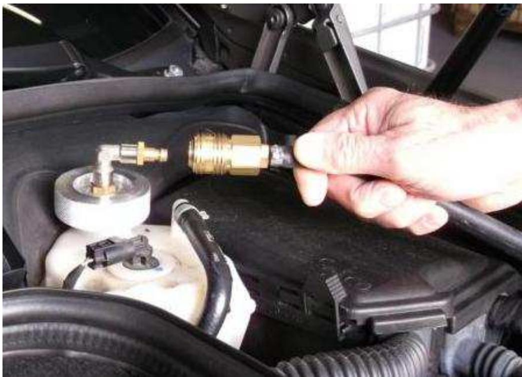
Schrauben Sie jetzt den Adapter auf den Vorratsbehälter und schließen Sie den Druckschlauch (große Kupplung) an.
