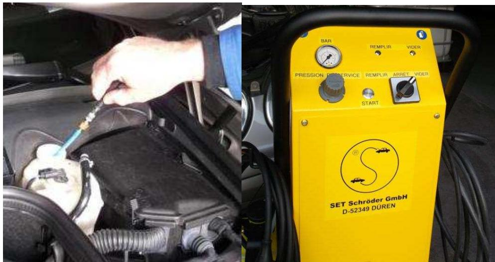
Öffnen Sie jetzt den Vorratsbehälter für Bremsflüssigkeit am Fahrzeug.
