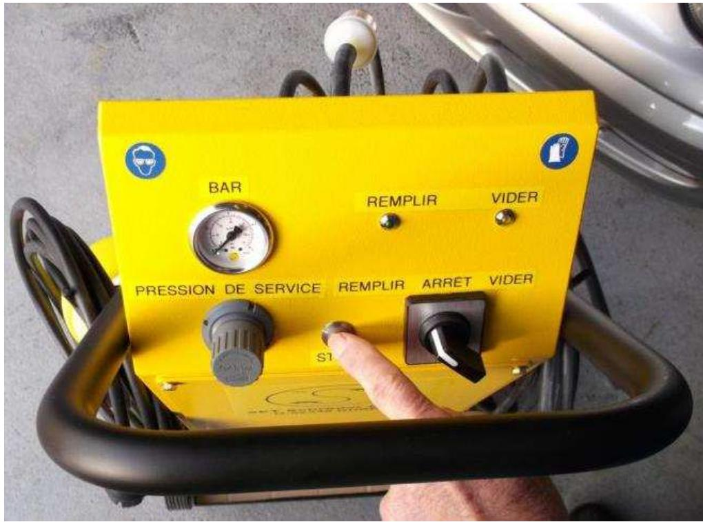
Jetzt schalten Sie das Gerät auf „BEFÜLLEN“ und drücken „START“. Sobald das Gerät einen Druck von mehr als 0,3 bar erreicht hat, können Sie die Starttaste loslassen.
