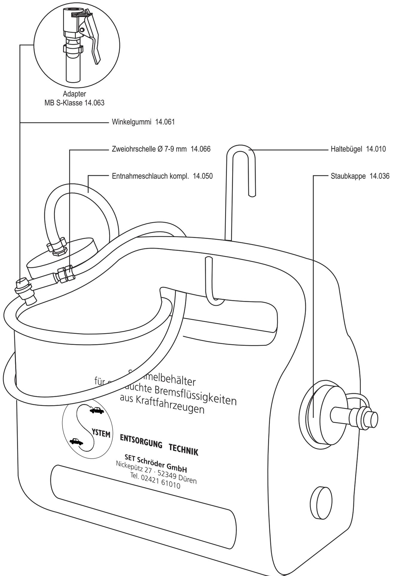
Entnahmebehälter Inhalt 3 Liter **14.002**
